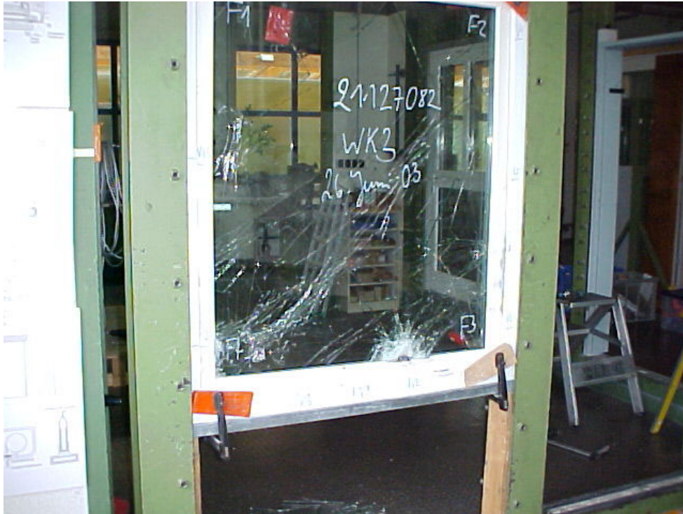
Bild 4 Schäden aus der manuellen Prüfung der Glasanbindung
