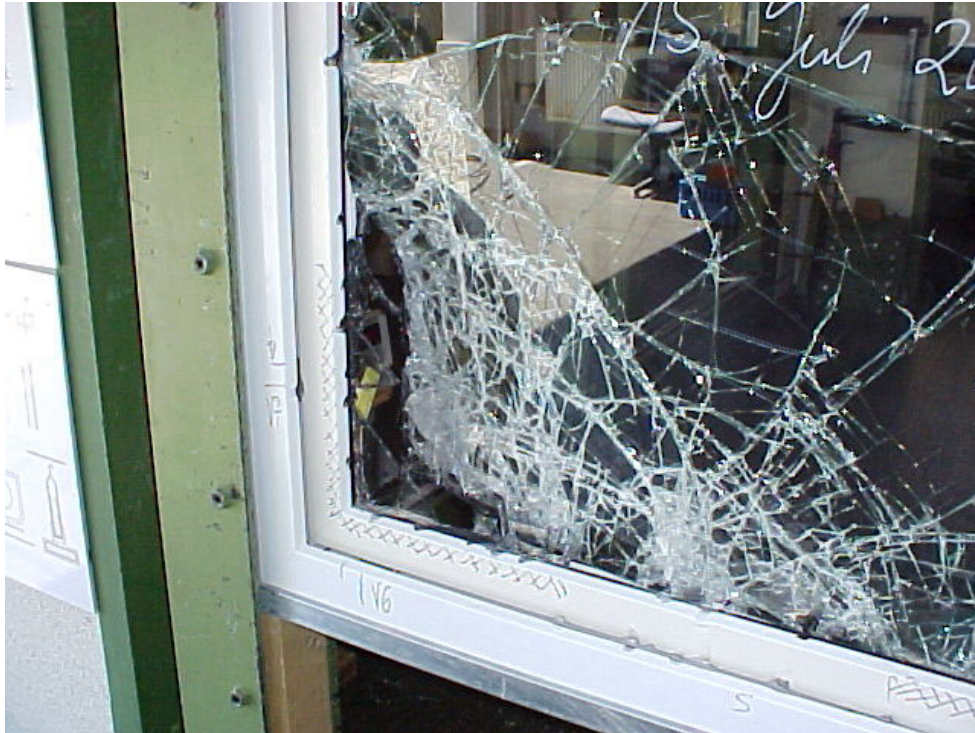
Bild 3 Schäden aus der manuellen Prüfung der Glasanbindung
