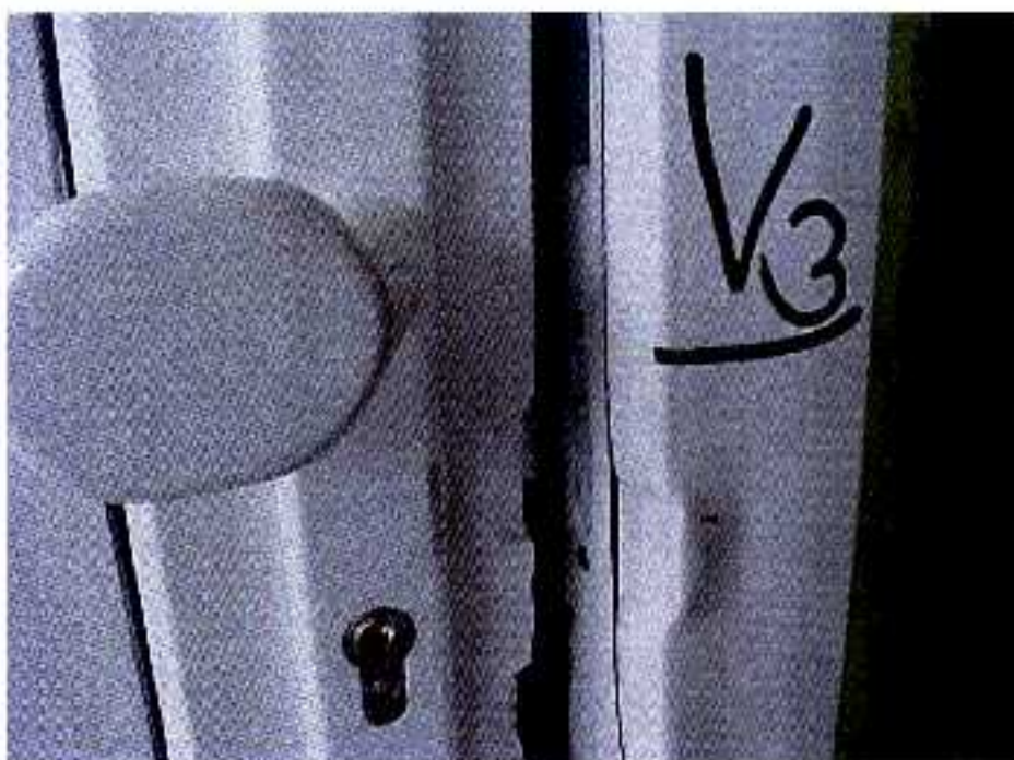
Bild 4: Schäden aus der manuellen Prüfung auf der Schlossseite
