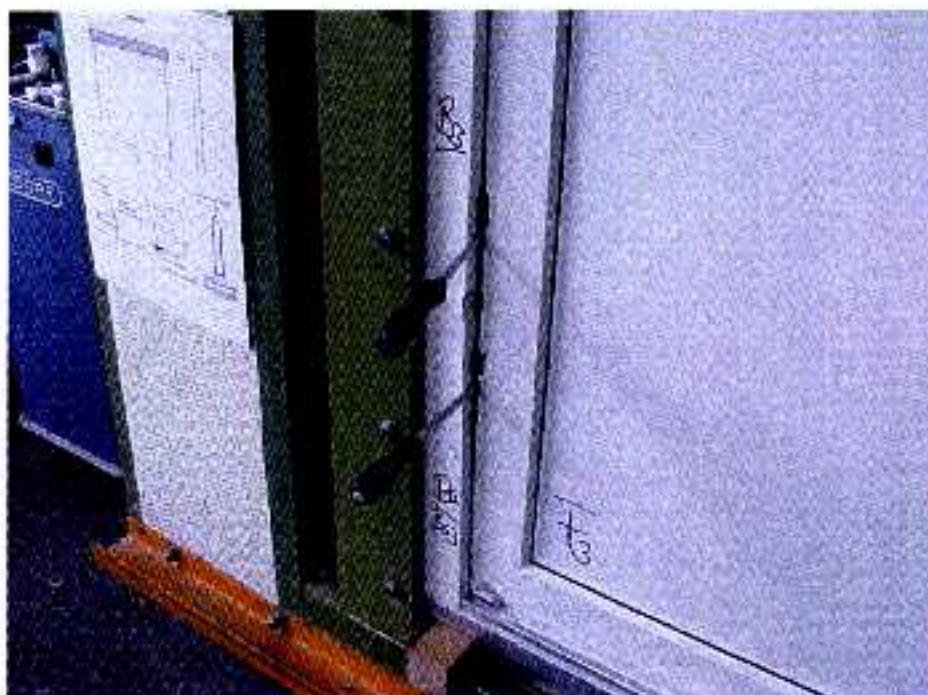
Bild 3: Schäden aus der manuellen Prüfung auf der Bandseite
