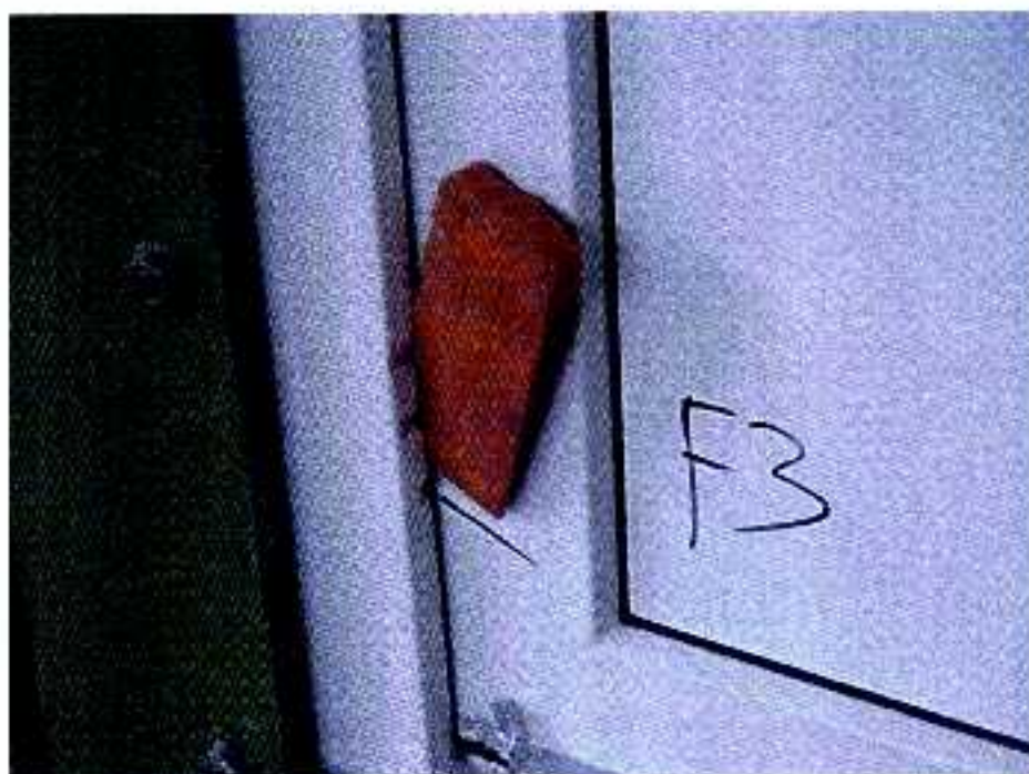
Bild 3: Schaden aus der manuellen Prüfung auf der Bandseite
