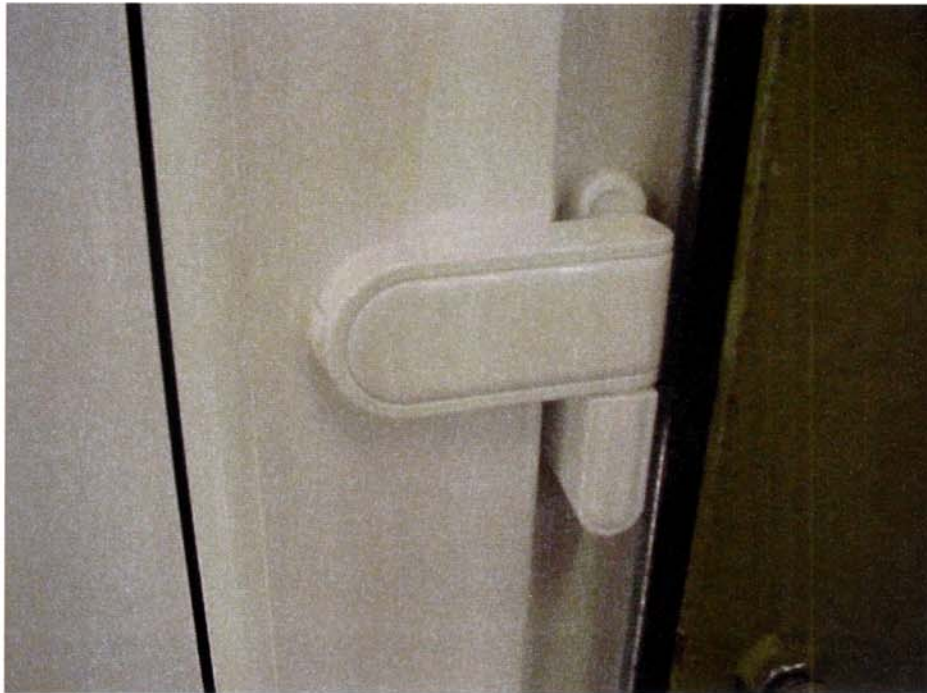
Bild 3: Beschlagteile des Prüfkörpers
