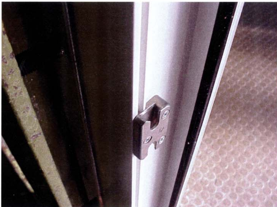
Bild 2: Beschlagteile des Prüfkörpers
